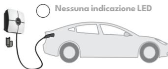
2- Inserire la spina di ricarica nel supporto della presa di ricarica della stazione.
